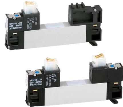
Elektrisch betätigtes Kolbenschieber-Ventil. Nach Zuschalten der Spannung wird das Ventil umgesteuert. Die Ventile sind mit einer tastenden Handhilfsbetätigung ausgestattet. Die Betätigung erfolgt über den Terminaldeckel mittels Schraubendreher.
