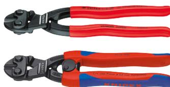
**Beschreibung:** Aus Chrom-Vanadium-Hochleistungsstahl geschmiedeter Bolzenschneider mit hoher Schneidleistung (Bolzen, Nieten usw. bis Ø 5,2 mm). Durch die neuartige Gelenkkonstruktion und die induktiv gehärteten Schneiden (ca. 64 HRC) ist der Kraftaufwand gegenüber eines Kraft-Seitenschneiders um ca. 60 % reduziert.
