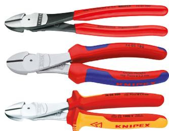
**Beschreibung:** Kraft-Seitenschneider mit hoher Kraftverstärkung für härteste Beanspruchungen. Präzisionsgeschliffene, induktiv gehärtete Schneiden (ca. 64 HRC) eignen sich zum Schneiden von jedem Draht (auch Pianodraht).
