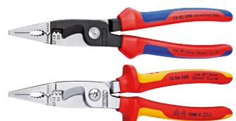
**Beschreibung:** Multi-Installationszange mit Greifzonen für Flach- und Rundmaterial, zum Biegen, Entgraten, Kabelschneiden von Kupferkabel bis Ø 15 mm (5 x 2,5 mm<sup>2</sup>) und Crimpen von Aderendhülsen (0,5 bis 2,5 mm<sup>2</sup>).
