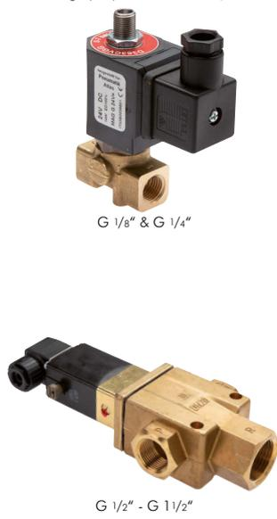
**Werkstoffe:** Körper: Messing (DN 25 & DN 40: Rotguss), Innenteile: Messing/Edelstahl, Dichtung: NBR (G 1/8"-G 1/4": FKM)
