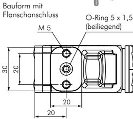
**Werkstoffe:** Körper: Zinkdruckguss/Aluminium pulverbeschichtet, Dichtungen/Membrane\*\*: NBR/PTFE
