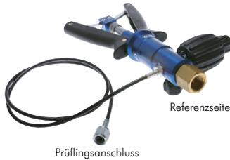
**Einsatzgebiet:** Zum Prüfen und Kalibrieren von Manometern und Druckmessumformern, Einstellen von Druckschaltern uvm. Mit dieser Handpumpe ist eine sehr einfache Prüfdruckerzeugung möglich. Ein Feinregulierventil stellt eine präzise Einstellung sicher. Das Druckreferenzgerät wird direkt oben in die Pumpe eingeschraubt.
