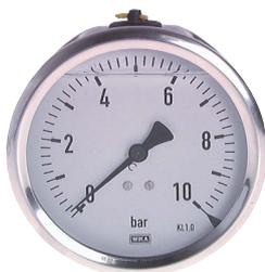
Werkstoffe: Gehäuse: 1.4301, Messsystem und Anschluss: 1.4404, Sichtscheibe: Mehrschichten-Sicherheitsglas
