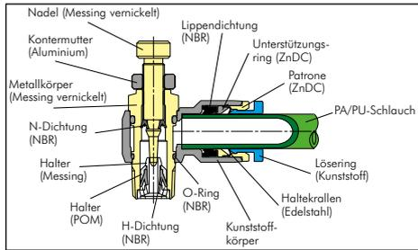
**Funktionsprinzip:** Drosselrückschlagventile drosseln den Durchfluss in einer Richtung, in der anderen Richtung ist der Durchfluss ungedrosselt. Standardform sind die Drosselrückschlagventile „abluffregelnd“. Sind diese in z.B. einen Zylinder eingeschraubt, ermöglichen diese einen gleichmäßigen Lauf ohne Slip-Stick-Effekt. Bei Zylindern mit kleinem Volumen (kleiner Durchmesser/geringer Hub), werden Drosselrückschlagventile in der Sonderform „zuluffregelnd“ eingesetzt.
