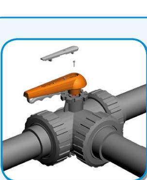
1. Para motorizar una válvula manual comenzamos quitando la tapa y liberando el tornillo, retirando finalmente la maneta.
