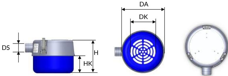
Abbildung: Wesentliche Abmessung des Universalgreifers A-F-H-R-150 für eine beispielhafte Konfiguration; Schematische Seitenansicht (links), Ansicht Greiffläche (mitte) und Draufsicht oben (rechts)
