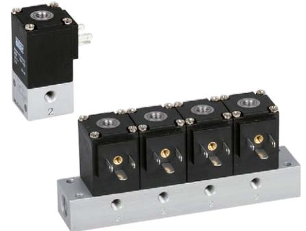
Elektrisch betätigtes Sitzventil. Nach Zuschalten der Spannung wird das Ventil umgesteuert. Die Ventile sind mit einer rastenden Handhilfsbetätigung ausgestattet. Die Betätigung erfolgt mittels Schraubendreher.
