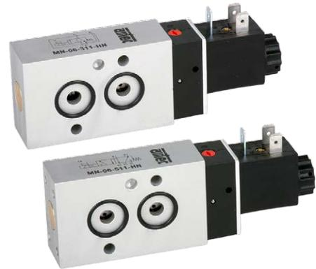
Elektrisch betätigtes Kolbenschieber-Ventil. Nach Zuschalten der Spannung wird das Ventil umgesteuert. Die Ventile sind mit einer rastenden Handhilfsbetätigung ausgestattet. Die Betätigung erfolgt mittels Schraubendreher. Befestigungsschrauben, Codierstift und O-Ringe gehören zum Lieferumfang.
